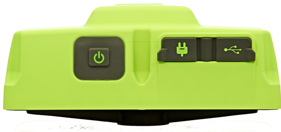
Рисунок 4. Кнопка вкл/выкл, разъемы питания и USB
