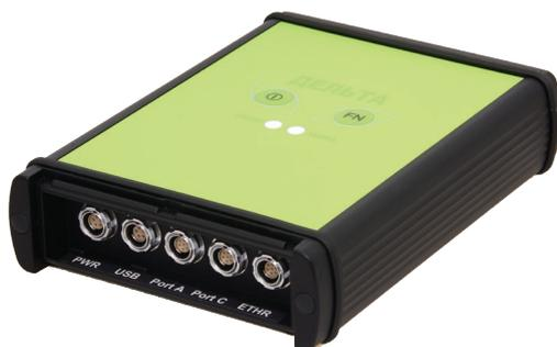
Дельта-3 - это мощный приемник для приложений, требующих высокой точности, например базовых станций и постоянно действующих базовых станций (ПДБС).
